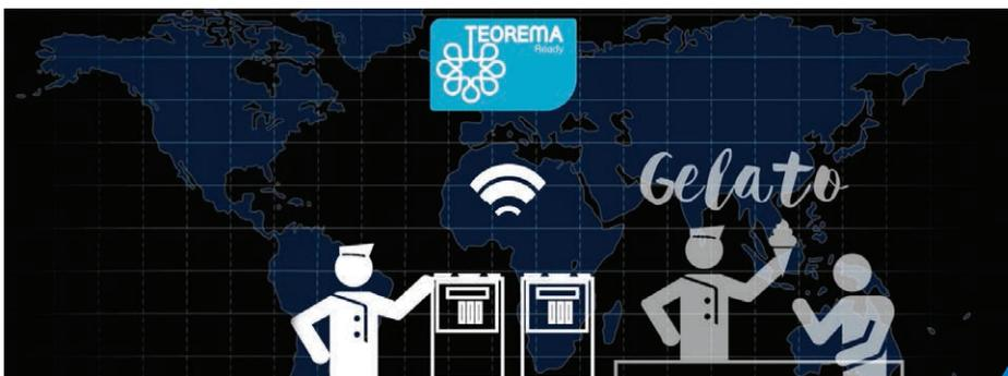
**Teorema.** Système de contrôle et diagnose pour surveillance à distance du fonctionnement de la machine. Le client peut accéder à la machine, par l'ordinateur, pour contrôler à distance l'opérativité. Teorema facilite, aussi, le service d'assistance : les techniciens Carpigiani peuvent accéder à des informations à distance et agir sur les paramètres de configuration comme si opéraient directement sur la machine.
